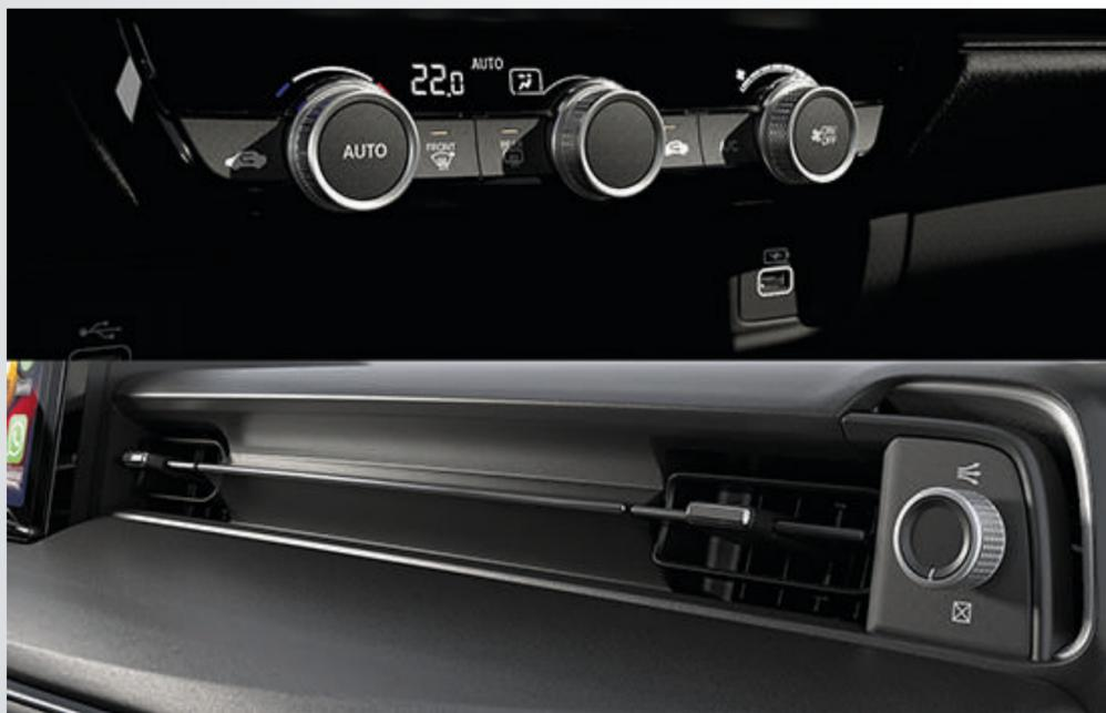
Sistema de climatización con tecnología bizona, que permite al conductor y acompañante regular de forma independiente la temperatura del aire. Además del sistema difusor de aire, que dirige el viento hacia las ventanas y hacia arriba, brindando mayor comodidad a los ocupantes.
