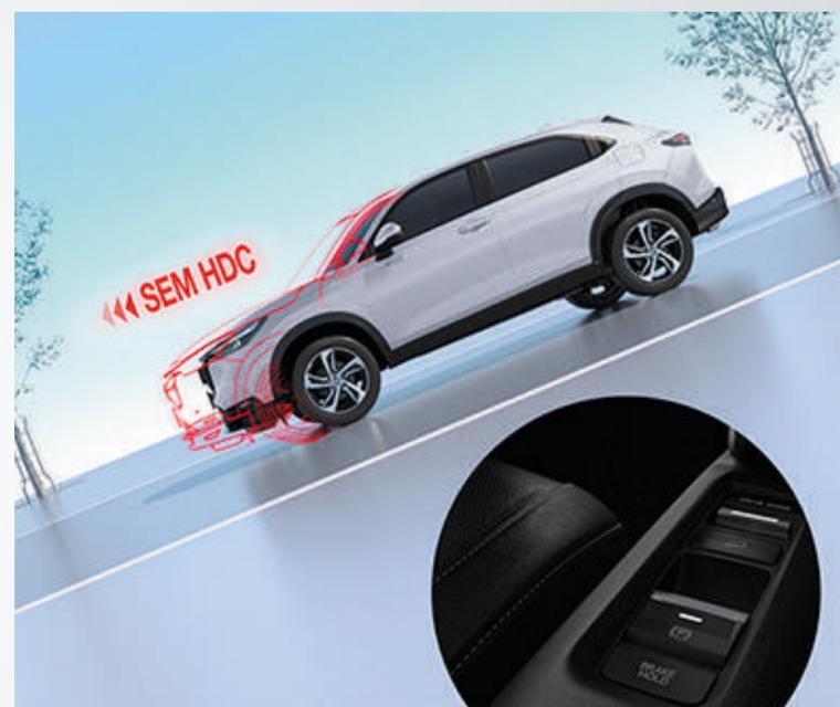
Además de todas estas tecnologías, la nueva HR-V cuenta con **frenos de disco en las 4 ruedas con tecnología ABS (Antilock Brake System) y EBD (Electronic Brake Distribution)** para un mejor control y eficiencia de frenada y **faros antiniebla LED** que aseguran una mejor visibilidad.
